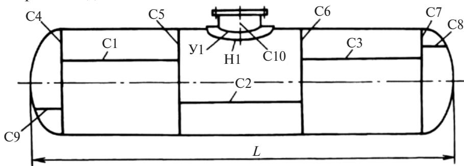
**Примечание.** Все участки сварных швов, подвергаемых контролю, в том числе места пересечения швов, должны быть обозначены на схеме.
