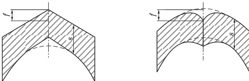
Рис. 1. Увод (угловатость) кромок в сварных швах
